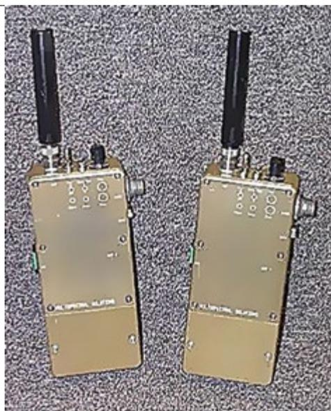
Рис. 5. UWB-приемопередатчик ORION L-диапазона
