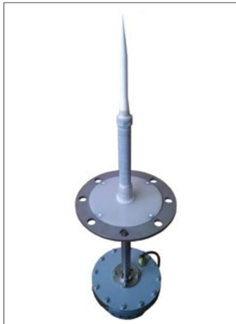
**Фото 5.** Исполнение радиолокационного уровнемера со стержневой антенной и полностью фторопластовым защитным покрытием деталей, контактирующих с атмосферой резервуара. Применение – измерение уровня плавиковой (фтористоводородной) кислоты
