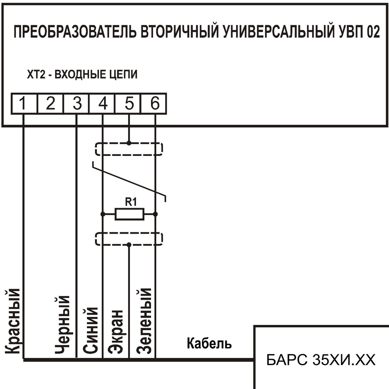
Рисунок Л.1 – Схема подключения радиоволнового преобразователя уровня исполнений БАРС 351И.20, БАРС 351И.22... БАРС 351И.38; БАРС 352И.20, БАРС 352И.22... БАРС 352И.38
