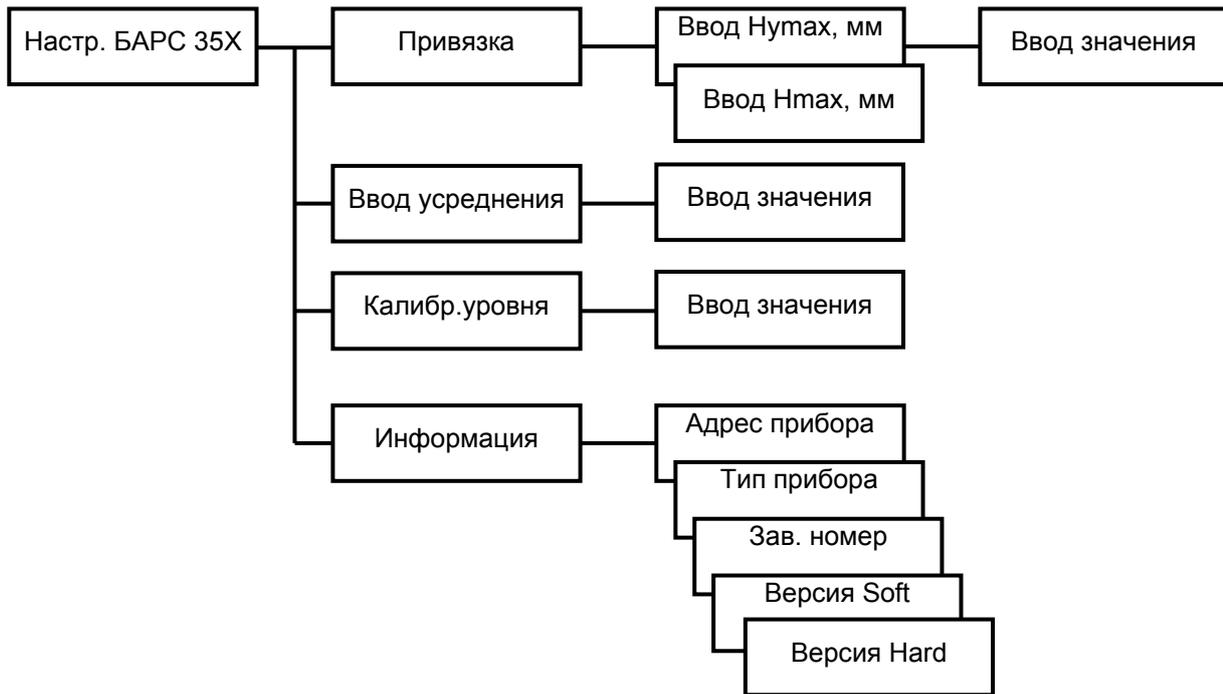
Рисунок К.2 – Меню настроек радиоволновых преобразователей уровня исполнений BARC 351И.00, BARC 351И.02...BARC 351И.18 и исполнений BARC 352И.00, BARC 352И.02...BARC 352И.18
