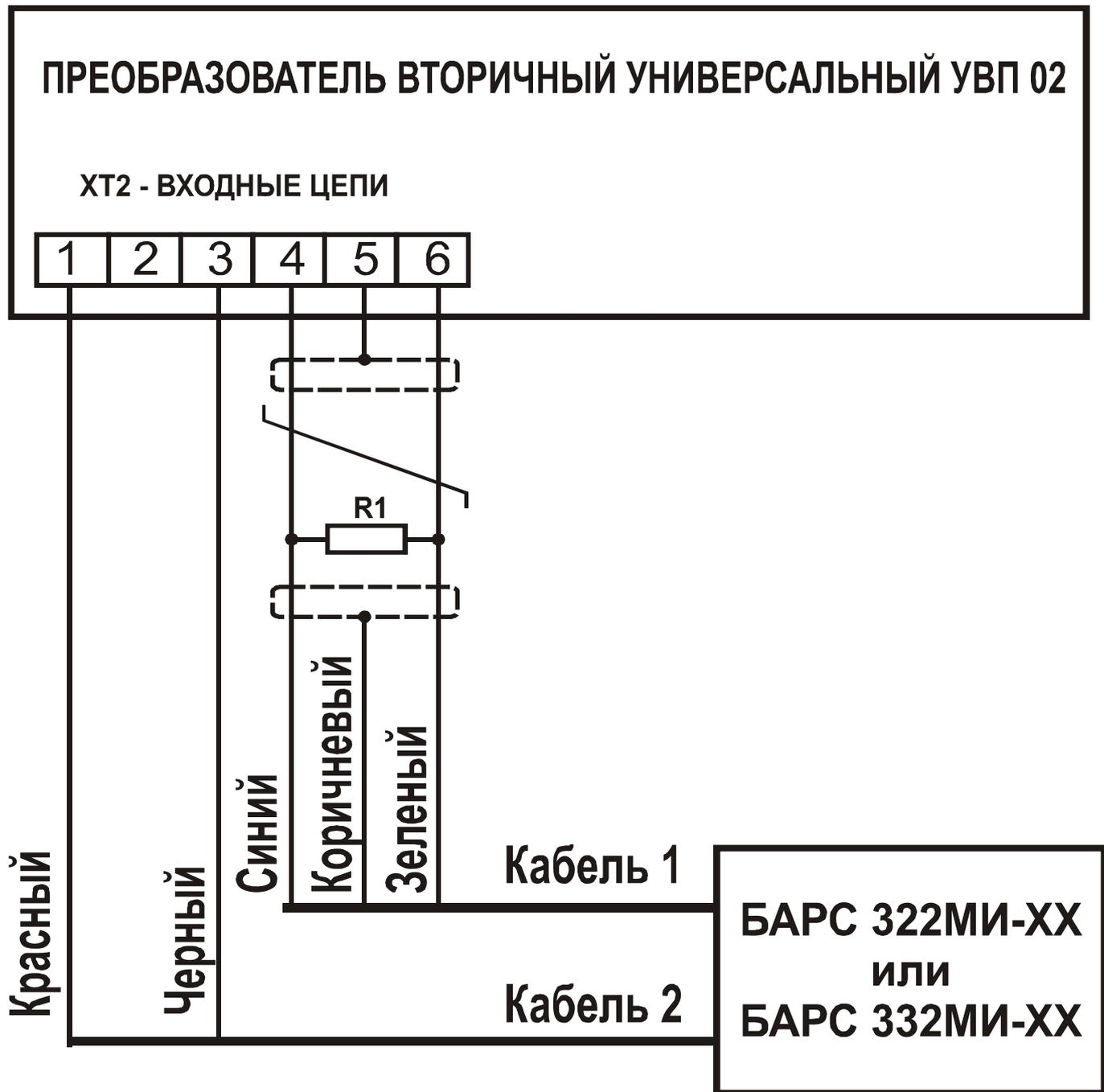
Рисунок И.1 – Схема электрическая подключения радиоволновых уровнемеров БАРС 322МИ-ХХ и БАРС 332МИ-ХХ к прибору
