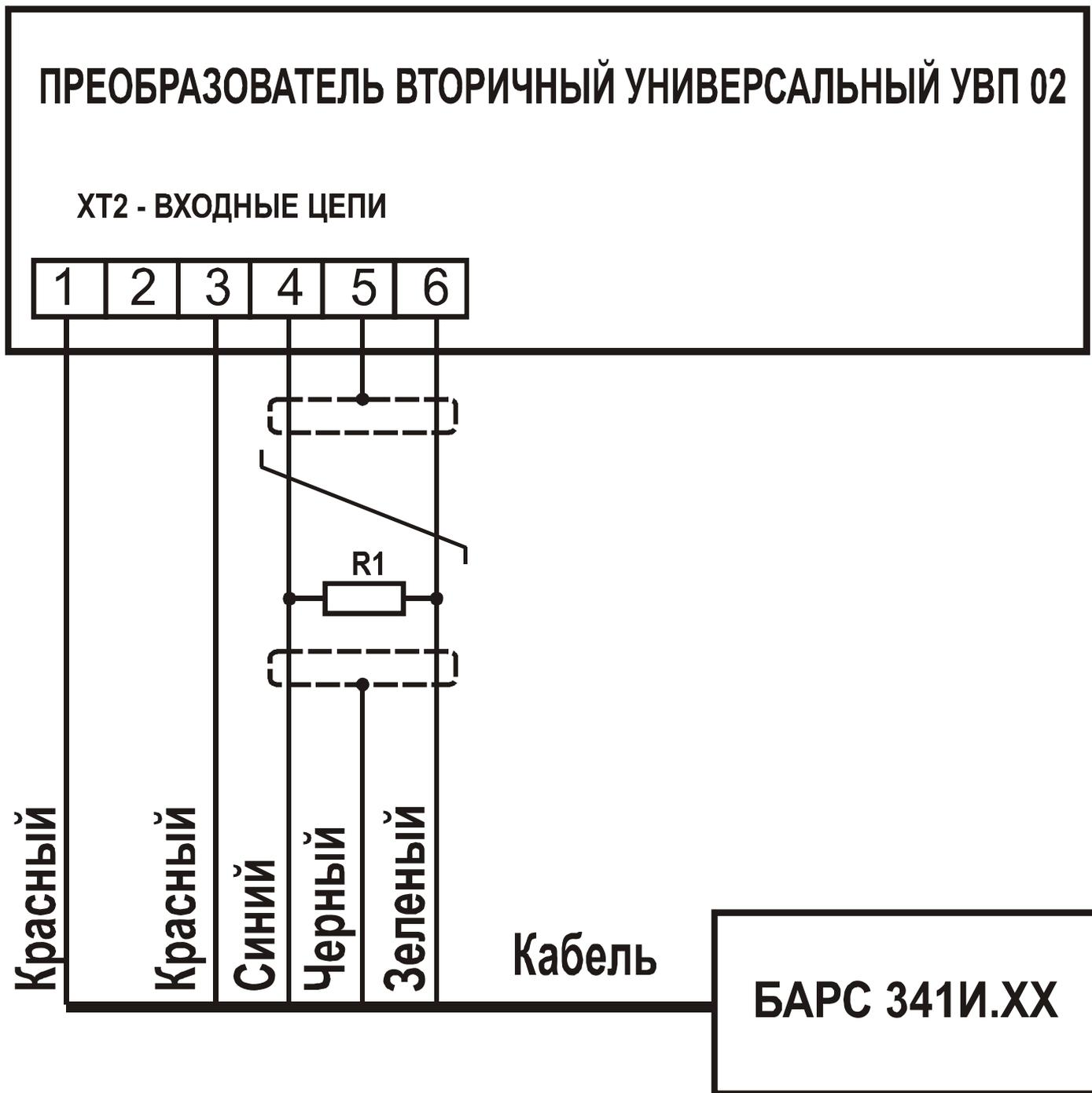
Рисунок Ж.1 – Схема электрическая подключения радиоволнового преобразователя уровня БАРС 341И.ХХ ТУ 4214-020-12196008-02 к прибору
