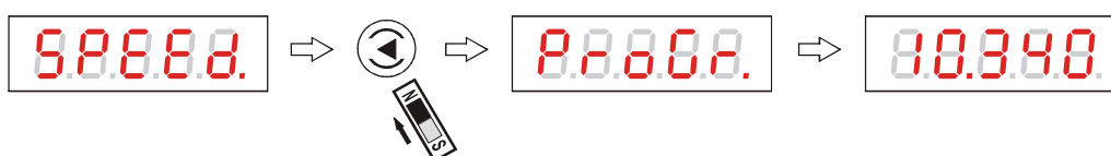
Рисунок 83 - Запись в память уровнемера введенных установочных параметров
