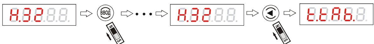
Рисунок 62 - Запись в память уровнемера 32 точек тарифовочной таблицы
