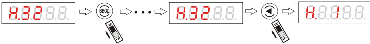
Рисунок 63 - Переход к повторному вводу тарифовочной таблицы при обнаружении уровнемером ошибок ввода
