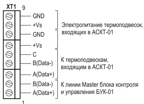
Рисунок 2 - Схема подключения ТУР-01
